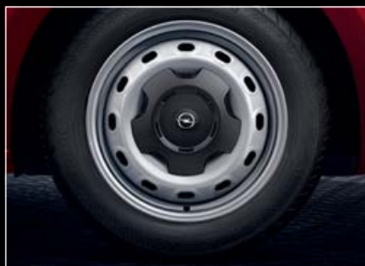
Llantas de acero de 16" con embellecedor central, 6 J x 16". Neumáticos 205/65 R 16.
