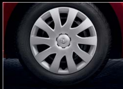
Llantas de acero, 6 J x 16", con embellecedor completo de 10 radios. Neumáticos 215/65 R 16.
