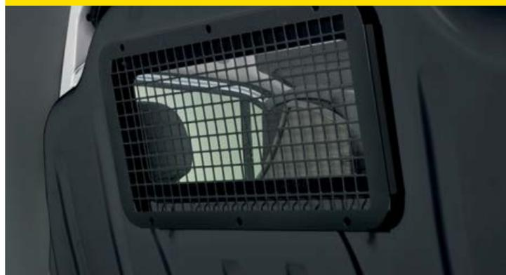
**10. Protección para la ventana de la mampara.** La resistente rejilla de acero protege el cristal sin dificultar la vista del área de carga. Cumple las normas ISO.
