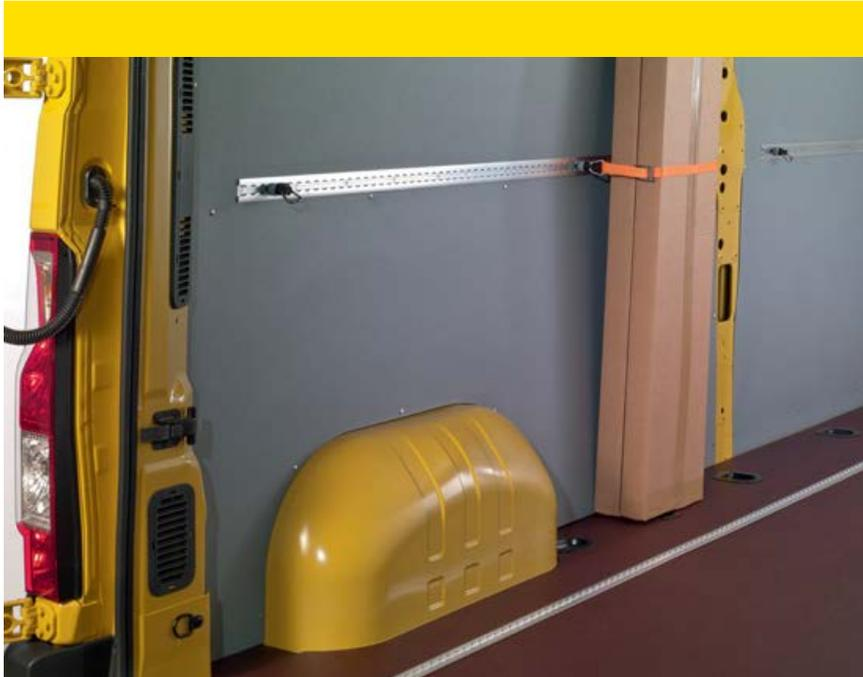
**4. Correas para los raíles laterales.** Las correas ajustables se fijan a los raíles de anclaje, permiten sujetar firmemente todo tipo de cargas en los laterales.
