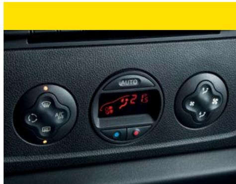
**4. Climatizador Electrónico Digital.** Mantiene con precisión la temperatura seleccionada, para lograrlo se ajusta automáticamente a las variaciones del clima exterior y de la luz solar.
