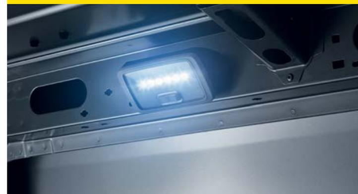
**11. Luz LED en el área de carga.** Clara y potente iluminación que facilita la tarea de carga o descarga.
