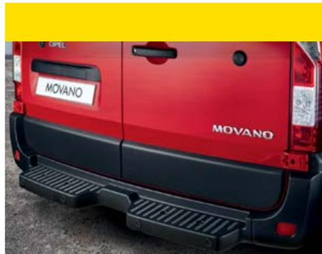
**10. Escalón trasero.** Con superficie antideslizante, facilita el acceso al área de carga. De serie en modelos con tracción trasera (RWD), opcional en modelos con tracción delantera (FWD).
