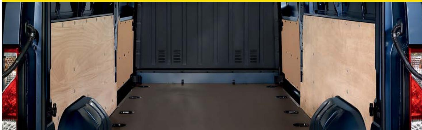
**9. Protección del área de carga.** Incluye suelo de madera plastificado y paneles laterales de madera con media o plena altura. Diseñados a medida y con huecos para las anillas de anclaje. Evitan daños en las superficies metálicas durante la carga y el transporte.
