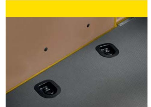
**5. Anillos de sujeción fijas.** Según la longitud del vehículo, el suelo del área de carga dispone de serie de 6, 8, 10 ó 12 anillos que permiten sujetar la carga con seguridad. Opcionalmente están disponibles 4 anillos situadas en los laterales.
