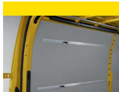
**6. Raíles laterales de anclaje.** Con puntos de fijación cada 25 mm, incluyen 6 anillos móviles que permiten asegurar todo tipo de cargas.
