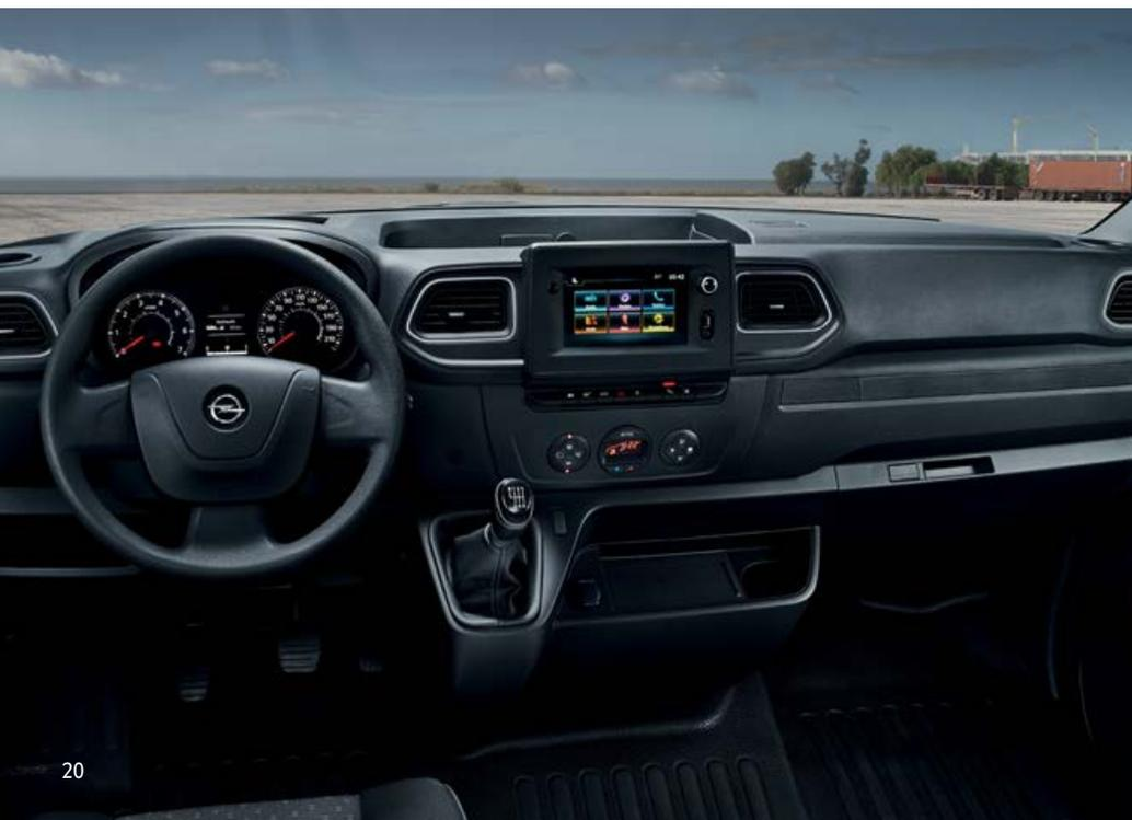
**Sistema Multimedia con Navegación Navi 50 IntelliLink Pro.** Un avanzado sistema con una excelente relación precio-prestaciones. Su pantalla táctil en color de 7" situada en el centro del salpicadero ofrece una visión óptima que evita distracciones. La navegación dinámica proporciona claras indicaciones e incluye mapas de Europa Occidental y Oriental fácilmente actualizables.
