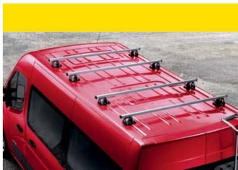
**1. Soporte base para el techo.** Ligero y resistente, sus barras de aluminio transversales transportan cargas de gran longitud y de hasta 200 kg, como tuberías, andamios, etc.
