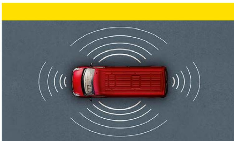
**5. Sistema de alarma antirrobo.** Se activa con el mando a distancia, protege el vehículo contra la intrusión mediante sensores de movimiento volumétricos situados en el compartimento del motor, la cabina y el área de carga.
